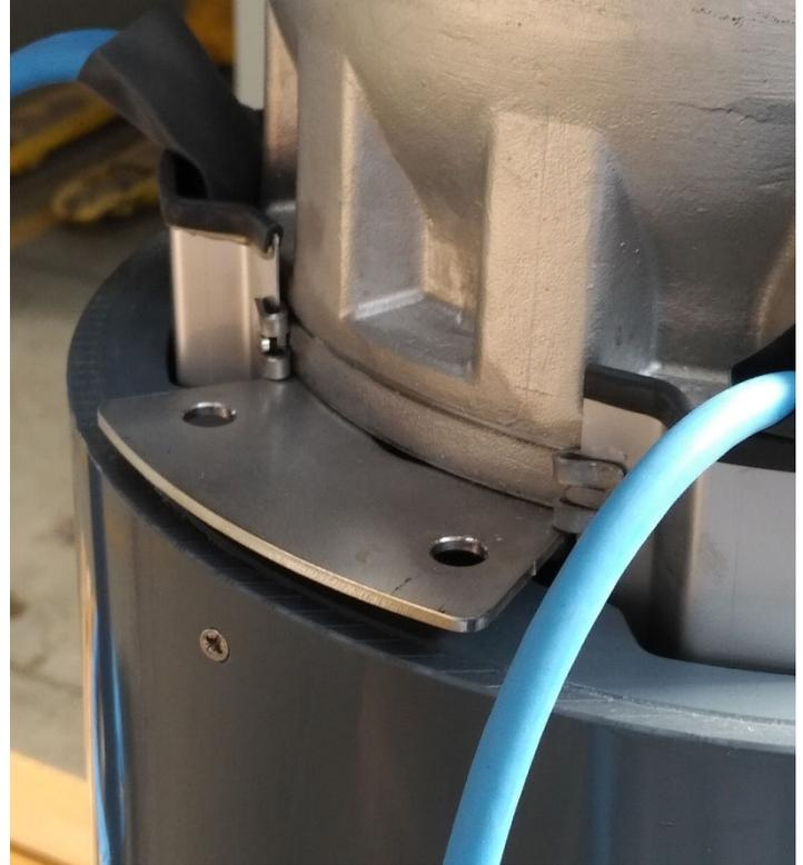
Alle sechs Schrauben, im Lieferumfang enthalten, mit einer Unterlegscheibe versehen und von Hand einschrauben. Schrauben dabei nicht verkanten. Es könnten die Gewinde beschädigt werden.
