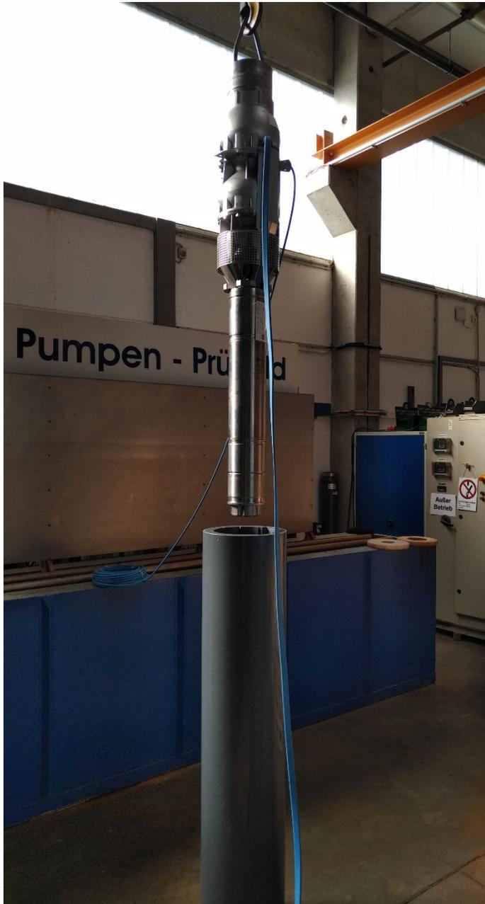
Pumpe langsam in den Kühlkörper ablassen.
