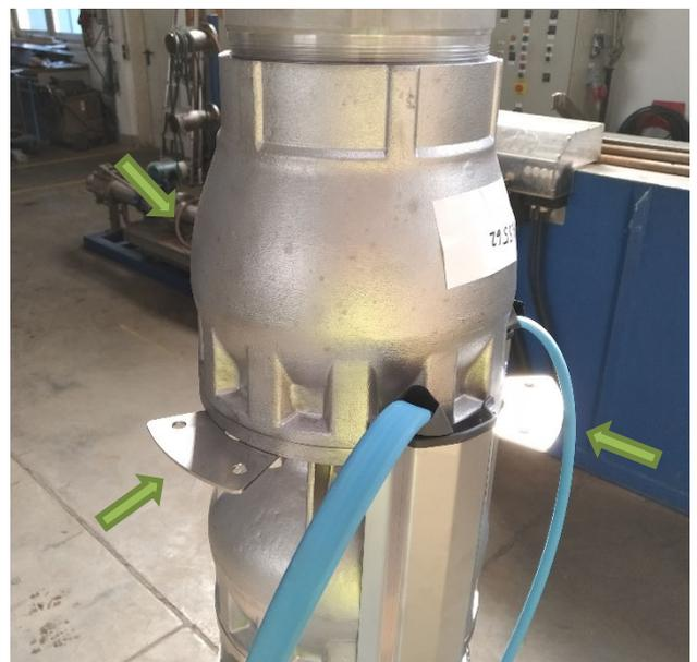
Die Pumpen für diesen Kühlmanteltyp werden mit drei Haltebleche für den Kühlmantel geliefert. Diese Haltebleche werden im Werk vormontiert und sind in einem 120°-Winkel an einer der Kammern der Hydraulik angebracht.
