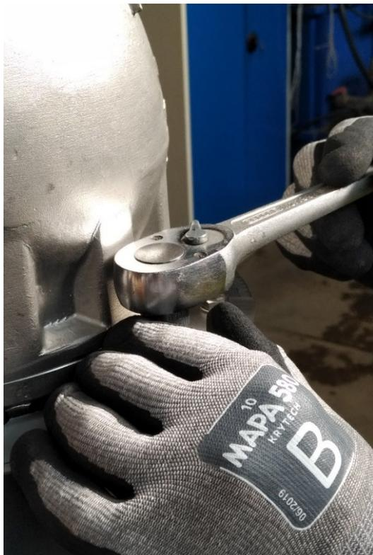
Die sechs Schrauben mit einem geeigneten Werkzeug handfest anziehen.
