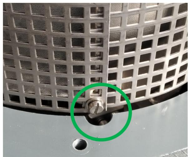
Beim Ablassen der Pumpe darauf achten, dass die Schraube des Einlaufsieves über der Aussparung im Befestigungsring steht. Sollte die Schraube neben der Aussparung liegen, kann sich der Kühlkörper verklemmen.
