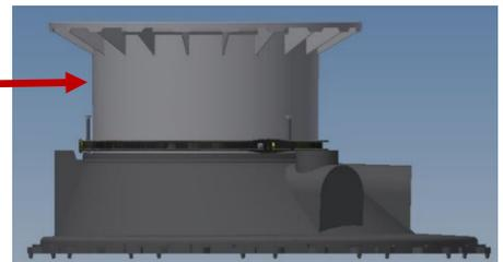
Der Schachtdom mit seiner Abdeckung ist Kraftflussentkoppelt vom Schachtgrundkörper ausgeführt und dadurch in der Variante KLB 125 bis zu einer Radlast von 12,5 to PKW befahrbar.
