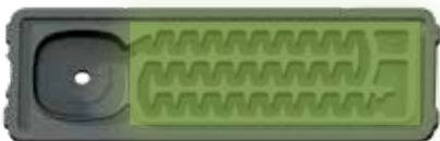
Die fortschrittliche Technik des Rivulis D5000 PC-Labyrinths stellt das ultimative Gleichgewicht zwischen gleichmäßiger Abnahme des Durchflusses und hoher Wirbelerzeugung im Tropfer dar, um sicherzustellen, dass die Festkörper gebunden werden. Rivulis D5000 PC verfügt über einen der größten Durchflusspfade, um Verstopfung zu vermeiden.
