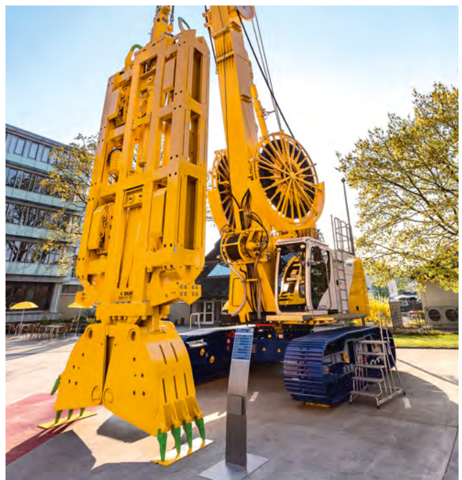
BAUER GB 50 Greifer – im Rahmen des KI-Forschungsprojekts OPAI4DNCS diente ein Gerät dieses Typs als Demonstrator.
