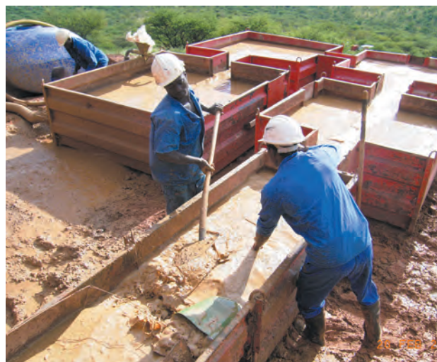
Spülungstanksystem für eine effektive Feststoffkontrolle
