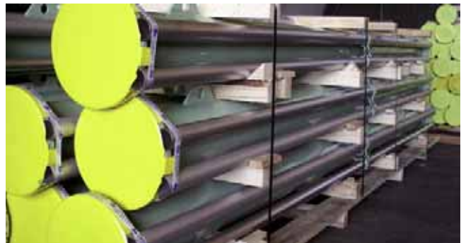
Pumpensteigrohre mit angebrachten Edelstahlpeilrohren
